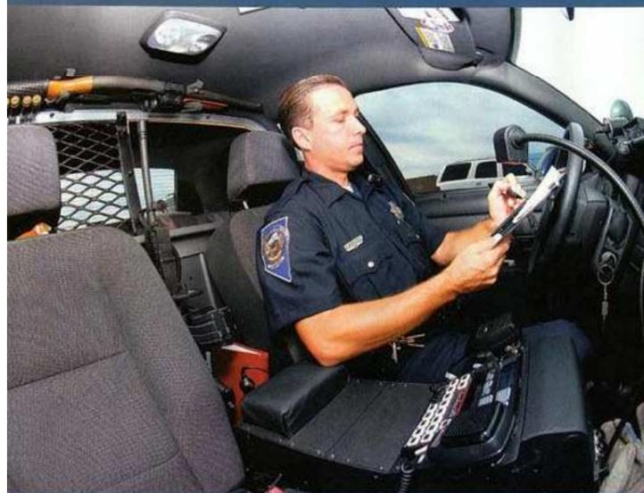
Dans l'habitacle, fixé au plafond de la voiture, le policier trouve à portée de main au-dessus de lui un fusil à pompe sécurisé dans son support, facilement déverrouillable grâce à une commande électrique habilement dissimulée.
